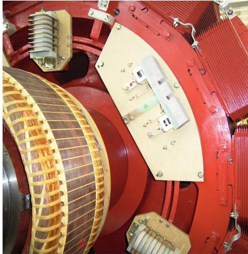
Figure 1.5 : Vu d'un rotor bobiné d'un moteur synchrone
