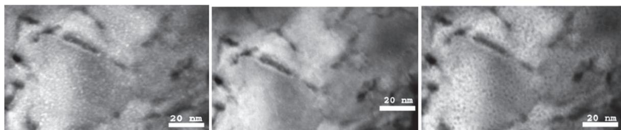
Figure 28 Clichés MET d'une feuille mince d'UO<sub>2</sub> implantée avec des ions Cs à 300 keV à différentes 10<sup>16</sup> Cs/cm<sup>2</sup> puis recuite pendant 20 min à 600 °C (Sabathier *et al.*, 2008). La présence de bulles nanométriques est visible grâce au jeu de focalisation du microscope : en (a) le faisceau est sous-focalisé, on observe des bulles claires, en (b) il est focalisé, les bulles ne sont pas visibles, et en (c), les bulles apparaissent dans un contraste sombre.
