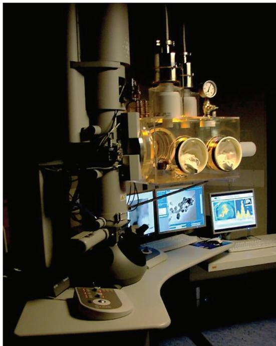
**Figure 46** Photo du MET du JRC-Karlsruhe. Il a été adapté à l'étude des matériaux nucléaires par l'ajout d'une boîte-à-gants. Un dispositif DTPE® de La Calhène est utilisé pour transférer les échantillons vers le microscope.
